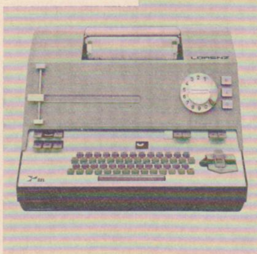
Lo 133 1967: Lorenz- Fernschreiber Lo 133 Automatik. Alle Fern- schreiber arbeiten nur noch nach dem von uns eingeführten Start-Stop-Prinzip.
