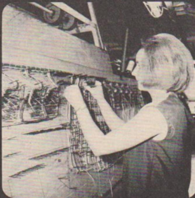
Ein unüberwindlicher Wirrwarr? Geübte Frauenhände finden durch. In der Kabelformerei entstehen Gestellrahmen-Drahtkabel.
