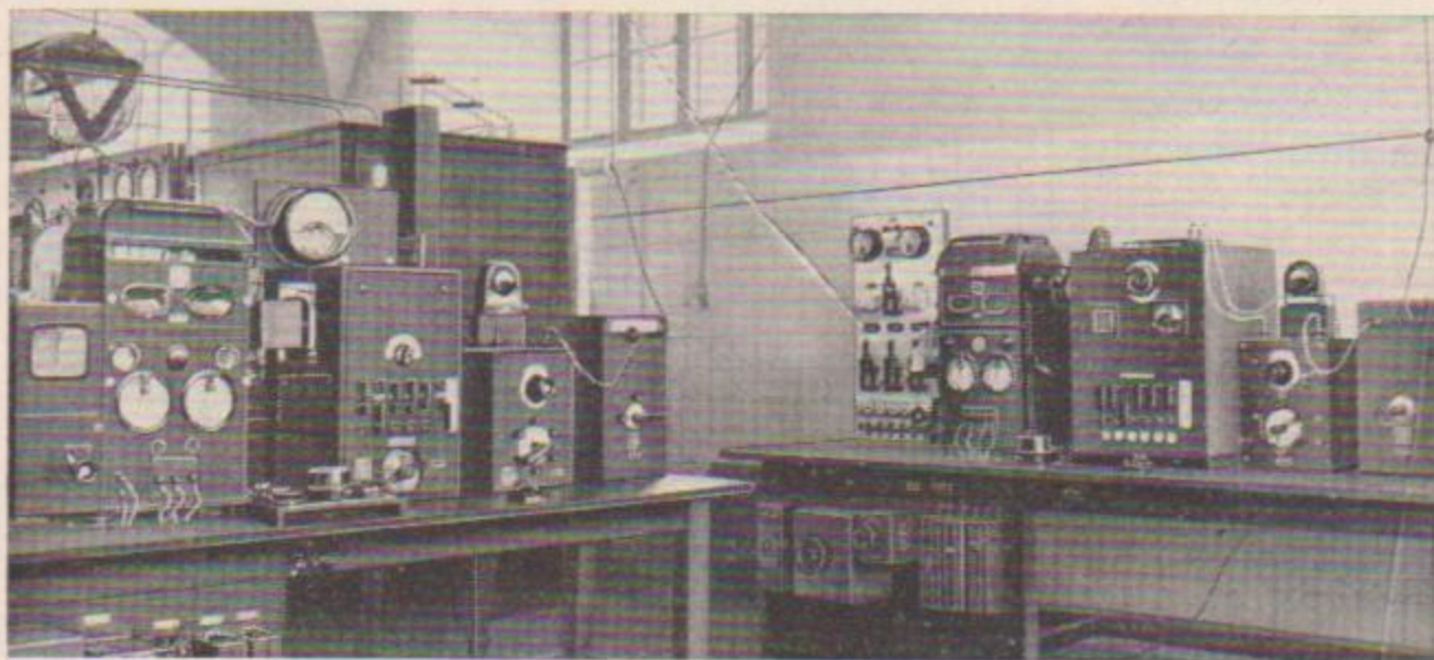
Eins der Kellerfenster, durch die ein Außenstehender weit in die Funkerherzen gucken konnte. Im Vordergrund kleinere Telefunken-Röhrensender für den europäischen Funkverkehr um 1922.
