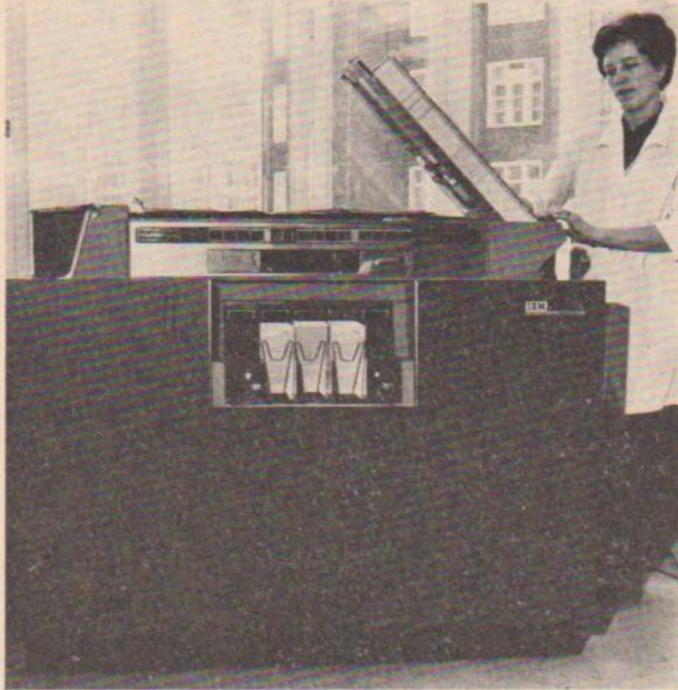
Der Kartenmischer IBM 088 vereinigt zwei Kartenstapel (links und rechts), die bereits nach gleichen Sortierbegriffen sortiert werden. Je nach Schaltung können bestimmte Karten in bestimmte Ablagefächer gesteuert werden.
