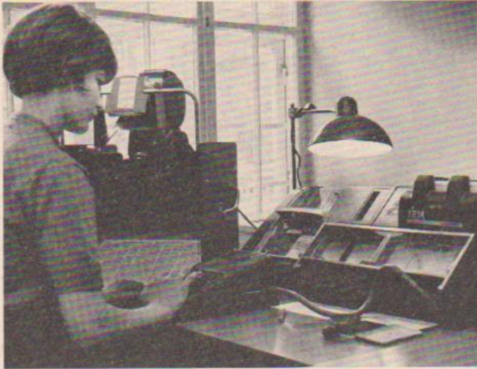
Am Kartenprüfer IBM 056 werden die zuvor am Kartenlocher in die Karten gelochten Daten durch ein erneutes Eintasten auf ihre Richtigkeit geprüft.
