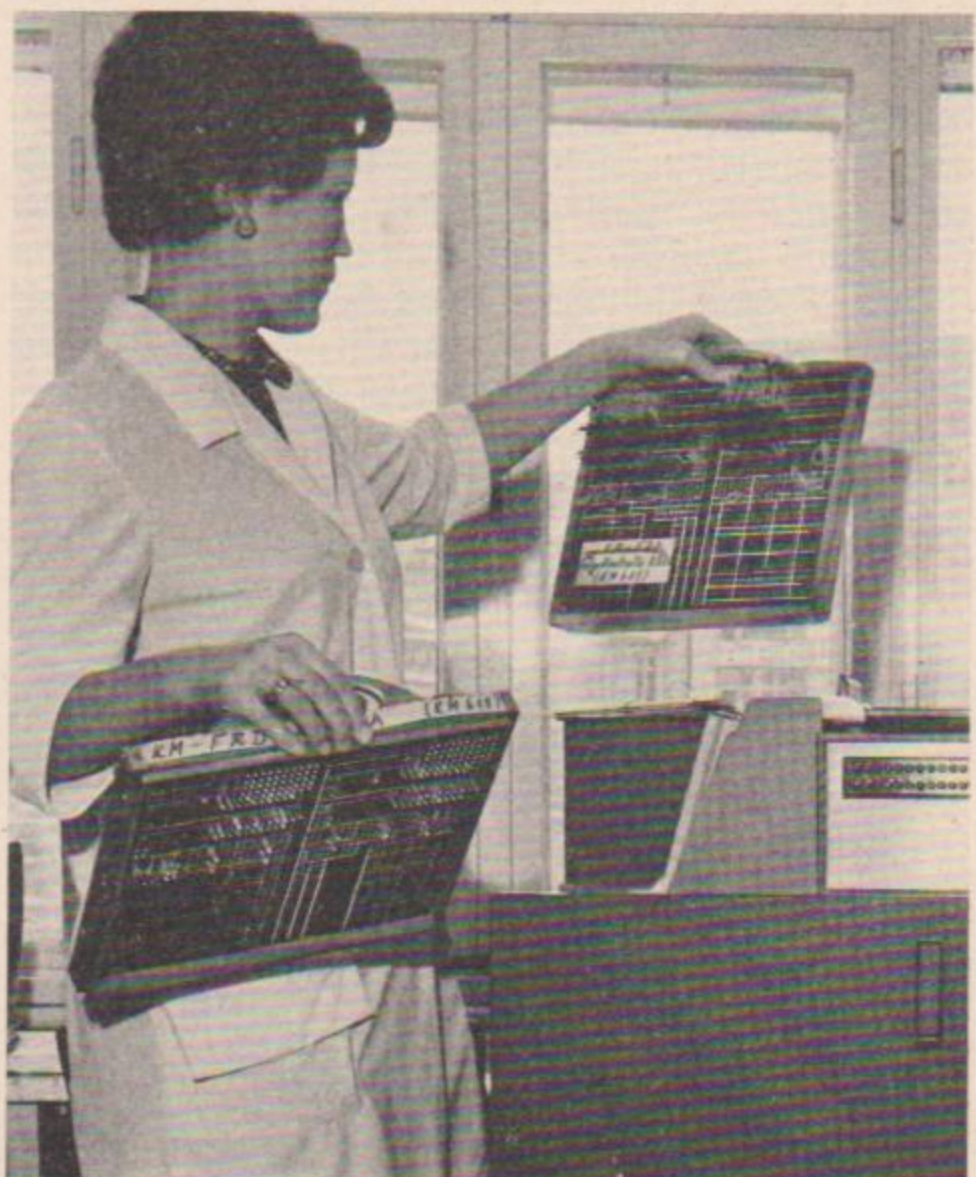
Der Kartenmischer IBM 088 und der Lochschriftübersetzer IBM 557 werden durch Schalttafeln gesteuert, die auswechselbar sind und für die jeweiligen Misch- oder Sortieraufgaben verschieden „gesteckt“ werden können.
