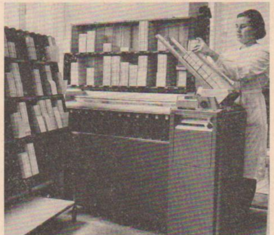
Die Sortiermaschine IBM 083 sortiert die Lochkarten nach einem bestimmten Sortierbegriff, und zwar jeweils nach einer Spalte in einem Durchlauf. Je nach dem Zeichen in dieser Spalte wird die Karte in eines der Ablagefächer gesteuert.
